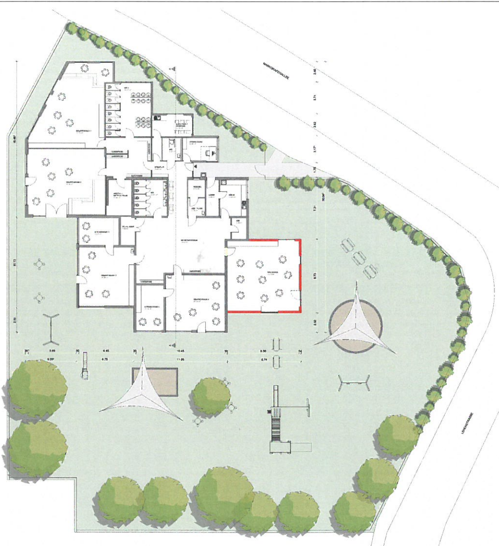
GRUNDRISS ERDGESCHOSS 2. BAUSCHNITT SPIELSAAL
