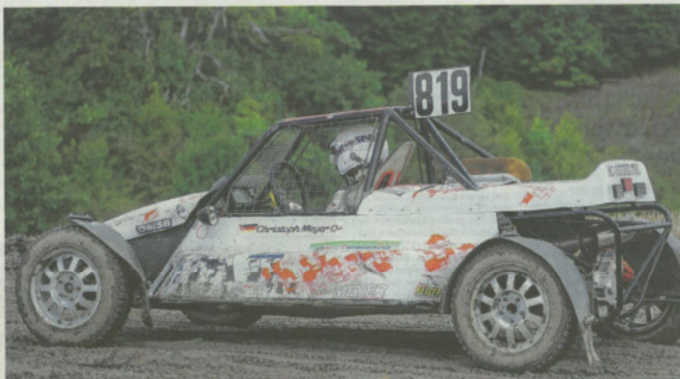
Dieser Teilnehmer der Auto-Cross-Veranstaltung ist mit einem Eigenbau auf der Strecke, der von Motorradmotoren angetrieben wird. Die Piste ist, nachdem es geregnet hat, schlammig. Der Kopf des Rennfahrers befindet sich in einer Art Käfig. Foto: Rainer Richter
